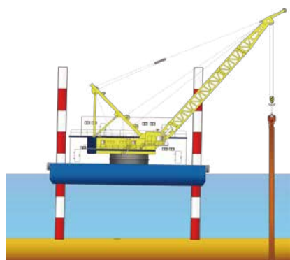
钢管桩拔出作业样图
