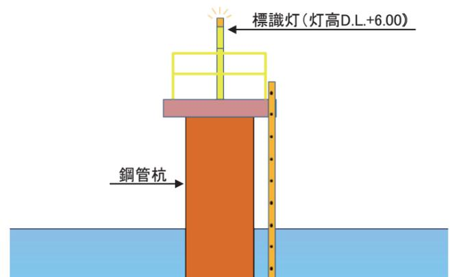
標識灯設置概要図(鋼管杭)
