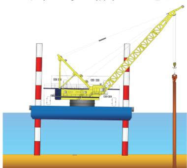
鋼管杭引抜き状況図
