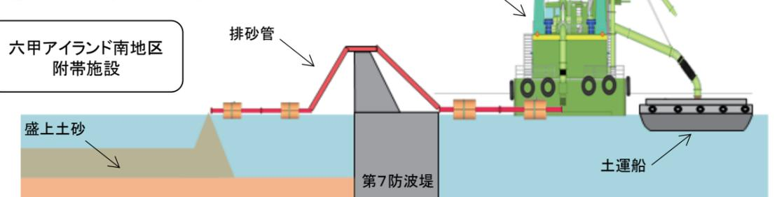
**敷砂、盛砂投入** ガット船で覆砂・盛砂を搬入し、投入します。
