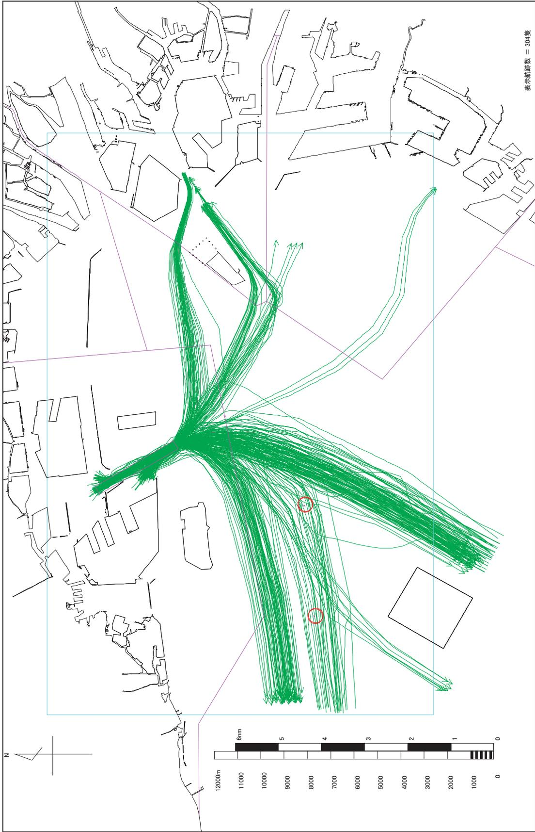
図 9.2.3 シミュレーション結果の航跡図 (現状一神戸中央航路通航船のみ)
