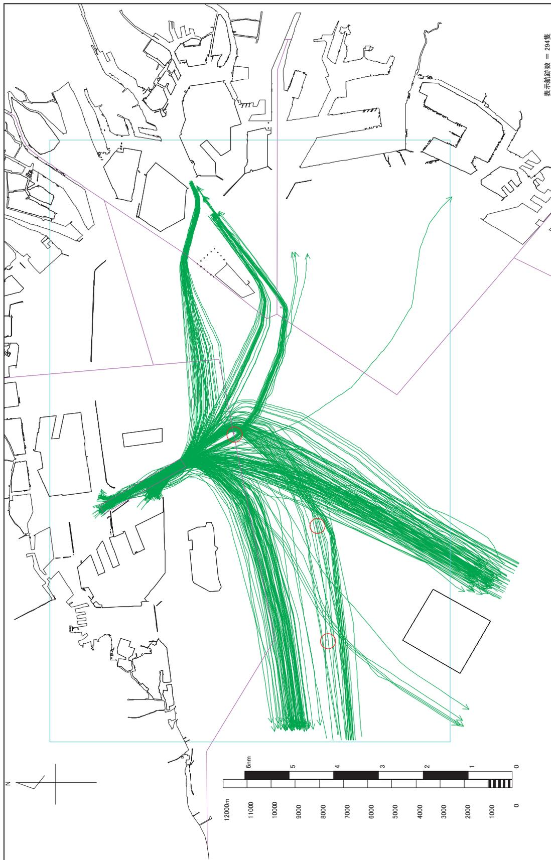
図 9.2.4 シミュレーション結果の航跡図 (新たな通航条件を適用一神戸中央航路通航船のみ)
