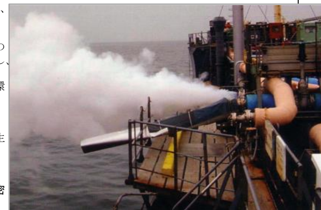
※ 参考資料 液化エチレンガスタンカーがエチレンガスを洋上で放出してタンクを減圧している状況
